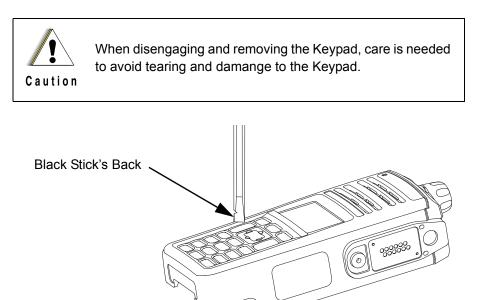
Figure 7-19. Disengage the Keypad
