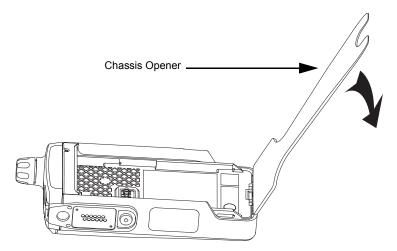
Figure 8-7. Disengage the Chassis
