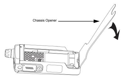
Figure 7-7. Disengage the Chassis
