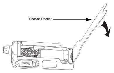
Figure 7-7. Disengage the Chassis
