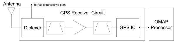
Figure 3-6. GPS Diagram
