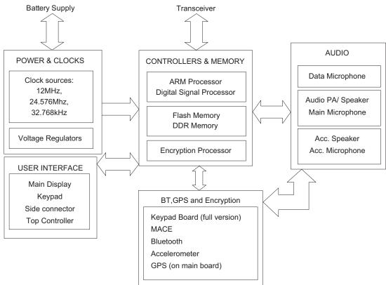
Figure 3-9. Controller Block Diagram
